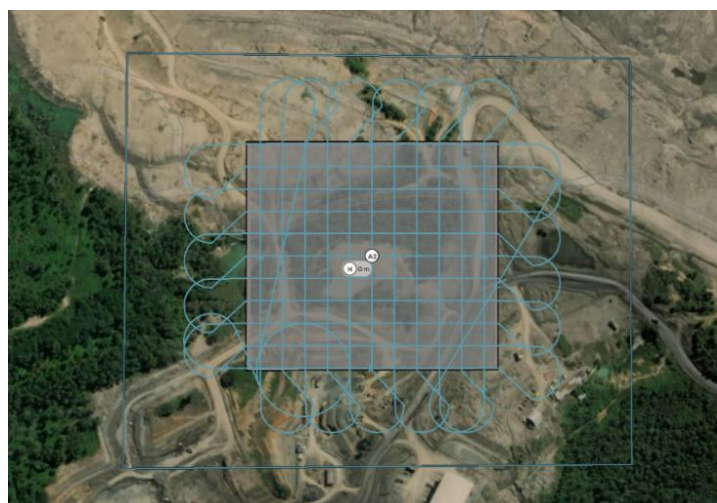
Gambar 1. Jalur terbang Doublegrid atau Cross-hatch arah horizontal dan vertikal Pada Stockpile di Site Banko Barat
