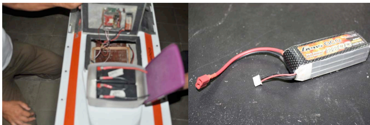
(a) (b) Gambar 7 (a) Aki kering untuk motor, dan (b) Baterai Lipo untuk receiver dan servo
