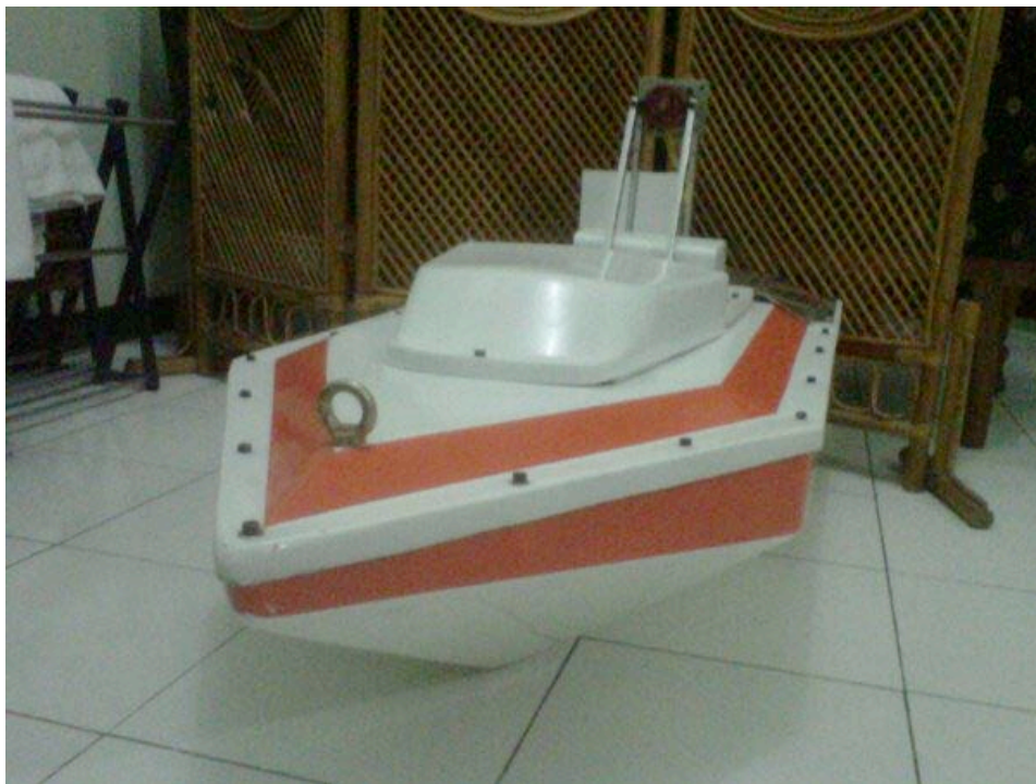
Gambar 4. Hasil rekonstruksi wahana apung berdasarkan master cetakan kedua (berhasil)
