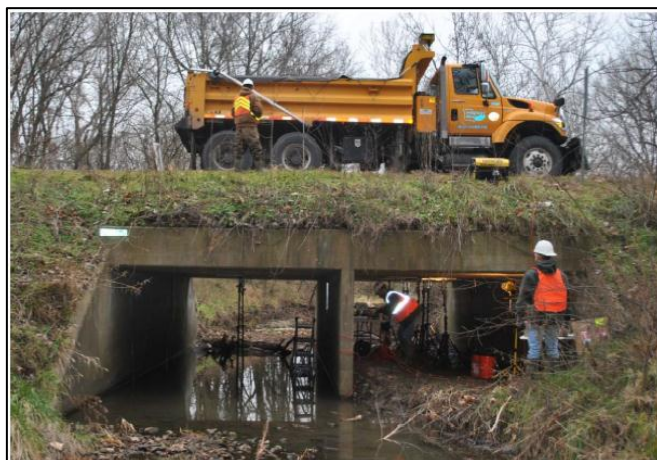
Gambar 2. Pengujian struktur dengan beban hidup truk (Sumber: Orton, S., 2013)
