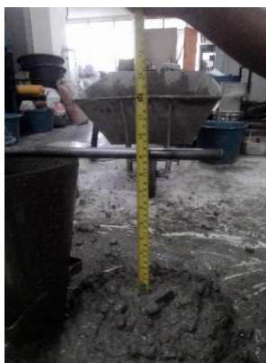
Gambar 11. Campuran beton segar yang mewakili nilai slump tinggi untuk volume pasir 0,24 \text{ m}^3/1 \text{ m}^3 beton
