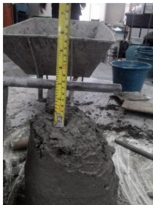
Gambar 12. Campuran beton segar yang mewakili nilai slump rata-rata rendah untuk volume pasir 0,28 \text{ m}^3/1 \text{ m}^3 beton
