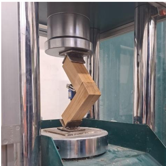
Gambar 3. Uji Kuat Tekan Sambungan Blind Mortise-Tenon
