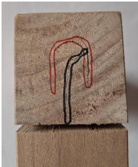
Gambar 10. Bentuk Kerusakan Sambungan
