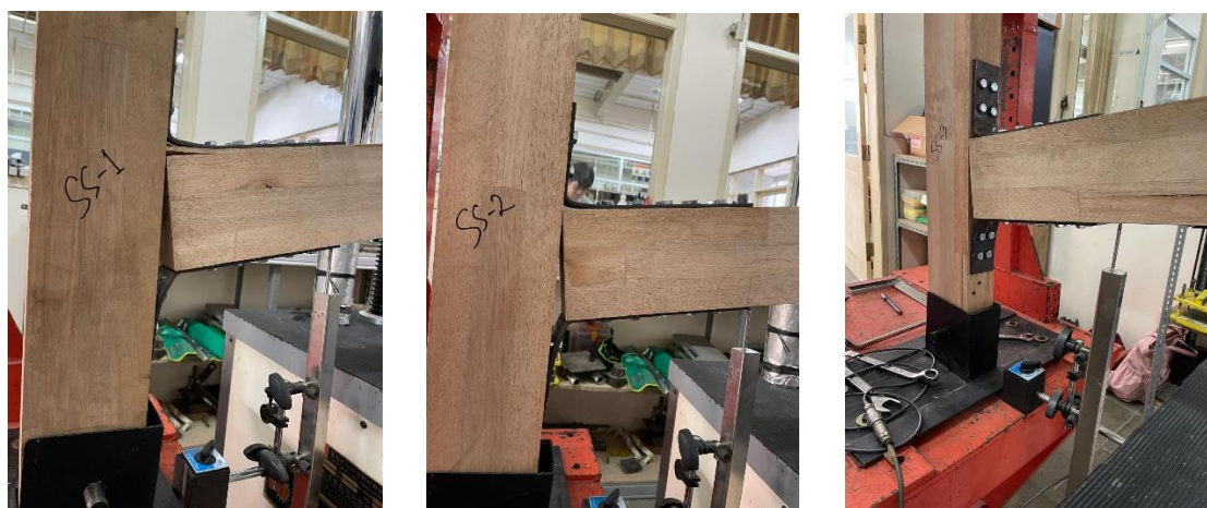
Gambar 5. Kondisi benda uji setelah pengujian (a) SS1, (b) SS2 dan (c) SS3
