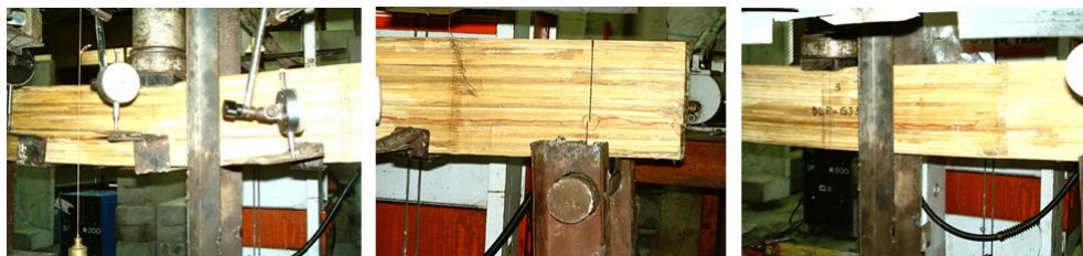
Gambar 5. Keruntuhan pada balok BLP-GJ [2]
