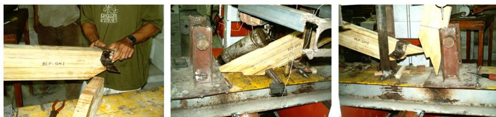
Gambar 6. Keruntuhan pada balok BLP-GM [2]
