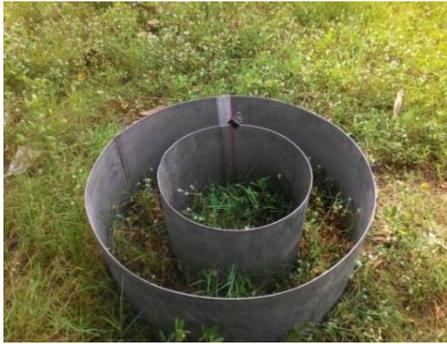
a. *Double ring infiltrometer*
