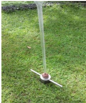
e. Pengukur daya resap tanah
