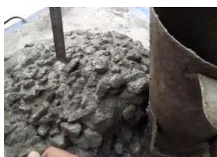
Gambar 12. Campuran beton segar yang mewakili nilai slump tinggi (160 – 185 mm)
