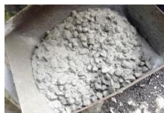
Gambar 13. Campuran beton segar yang mewakili nilai slump rendah ( 60 mm)
