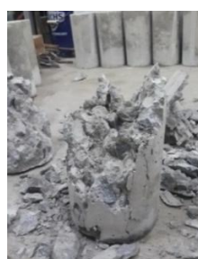
Gambar 11. Pola runtuh silinder beton pada campuran 18
