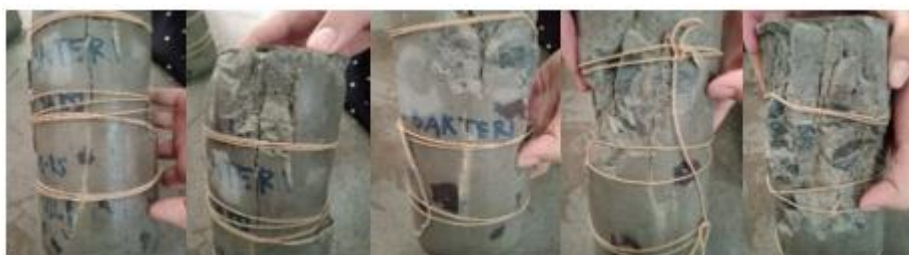
Gambar 3. Pengamatan self-healing pada beton hari ke-55 pasca pengujian
