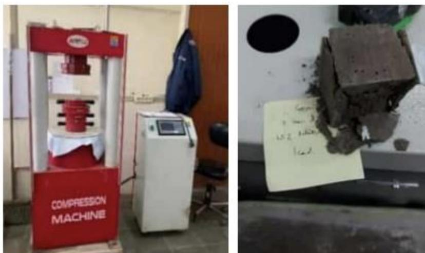
**Gambar 4. (a) Compression Test Machine; (b) Benda uji mortar setelah pengujian**
