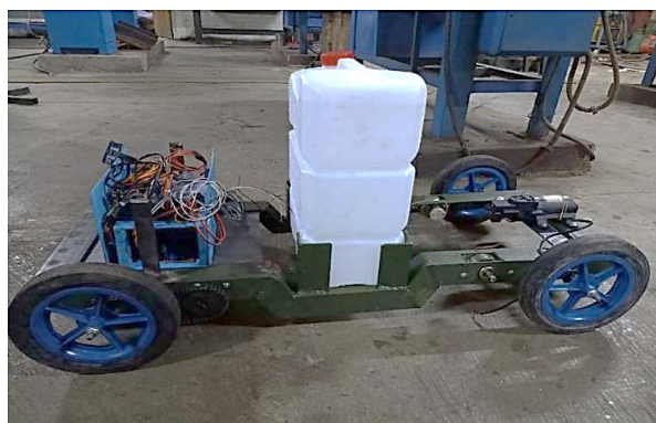
Gambar 3. Alat penyemprot hama (Azis Mahardika et al., 2021)
