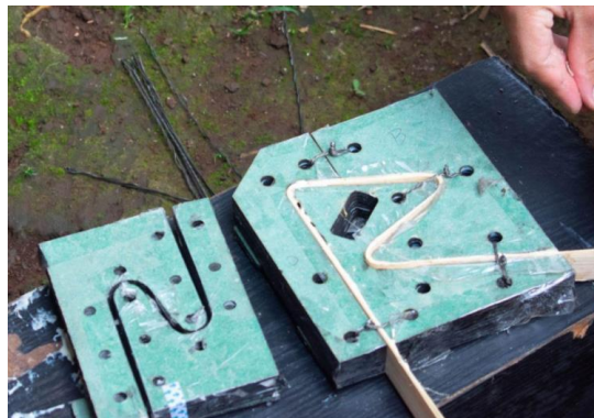
Gambar 8 Proses produksi kelom geulis bambu laminasi
