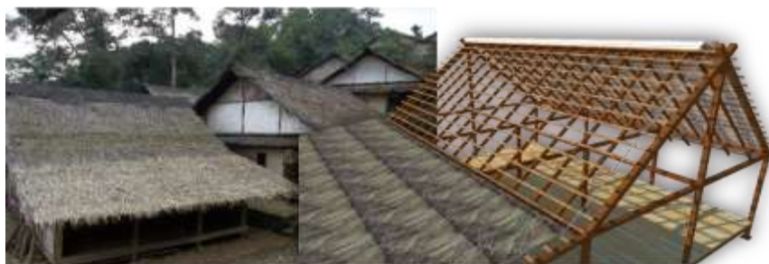
Gambar 5. Bangunan Baduy dan analisis struktur atap
