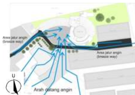
Gambar 22. Aliran angin yang melewati bangunan sekitar.
