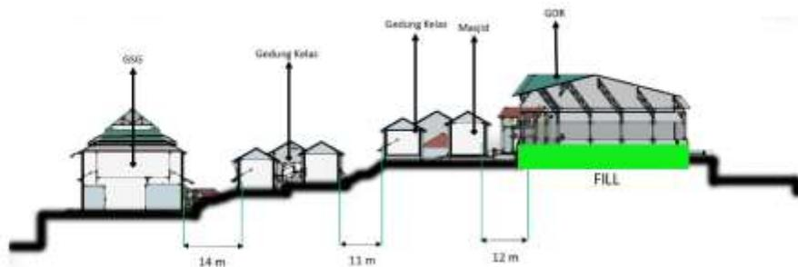
**Gambar 3. Analisis Jarak Antar Bangunan**
