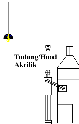
Gambar 2, Lampu Neon Dengan Tudung/Hood Dari Bahan Akrilik
