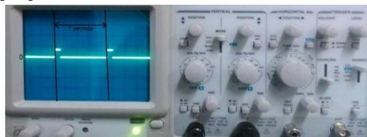
**Gambar 7. Sinyal PWM Keluaran Mikrocontroller *Duty Cycle* 10%**
