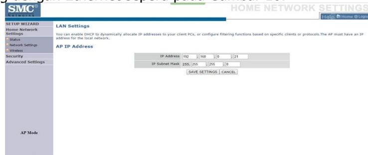
**Gambar 10. Pengaturan IP *router wireless***
