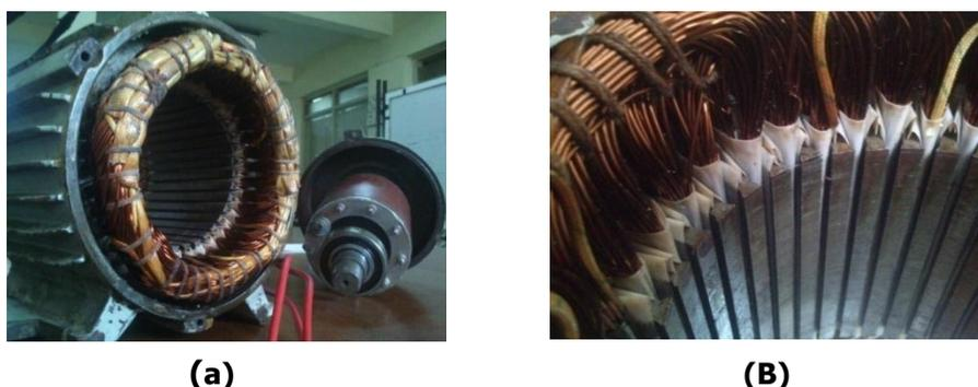
Gambar 9. (a) motor setelah di rewindin dan (b) lilitan tampak dalam
