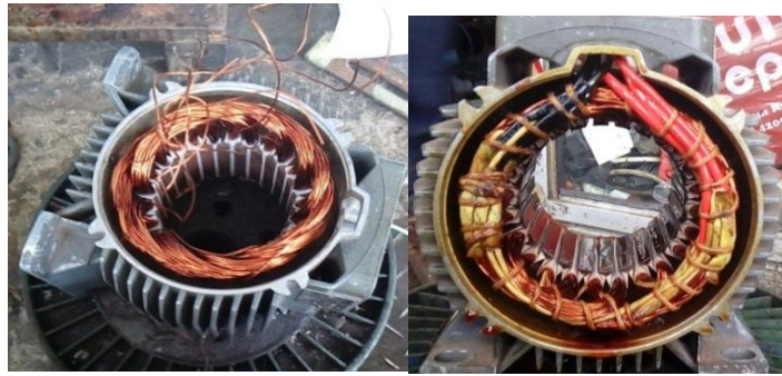
Gambar 8 (a) Saat rewinding Gambar 8 (b). Setelah rewinding Gambar 8. Belitan stator motor induksi yang dilakukan rewinding
