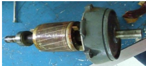
Gambar 2. Rotor sangkar motor induksi 3 fasa
