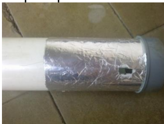
Gambar 6. Reflector antena yang sudah jadi
