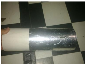
Gambar 5. Pipa paralon yang dilapisi aluminium foil
