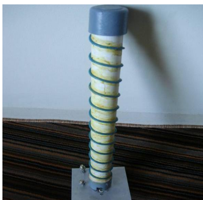
Gambar 2. Hasil Rancangan Antena Helik
