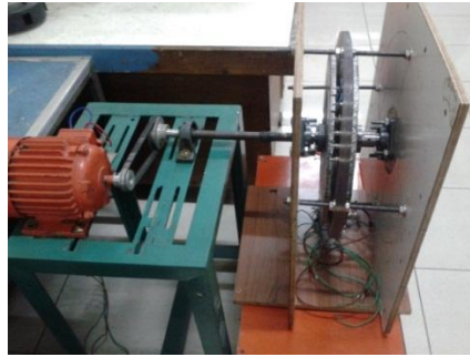
Gambar 3. penggerak generator menggunakan motor listrik
