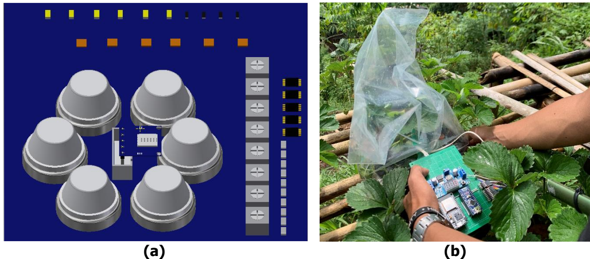
Gambar 1. (a) Desain Alat E-nose, (b) Implementasi Alat pada Tanaman Stroberi
