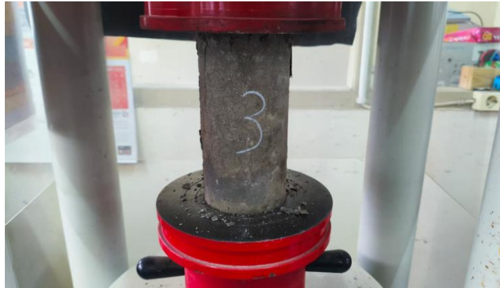
Gambar 3. Pengujian Kuat Tekan Menggunakan Alat Compression Machine
