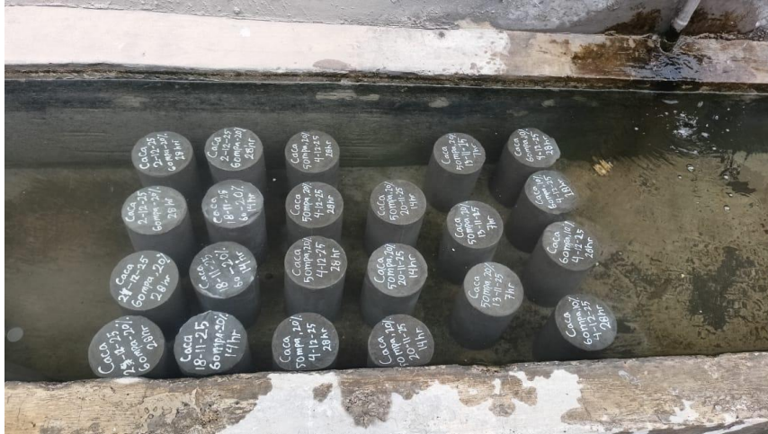
Gambar 2. Perawatan Benda Uji
