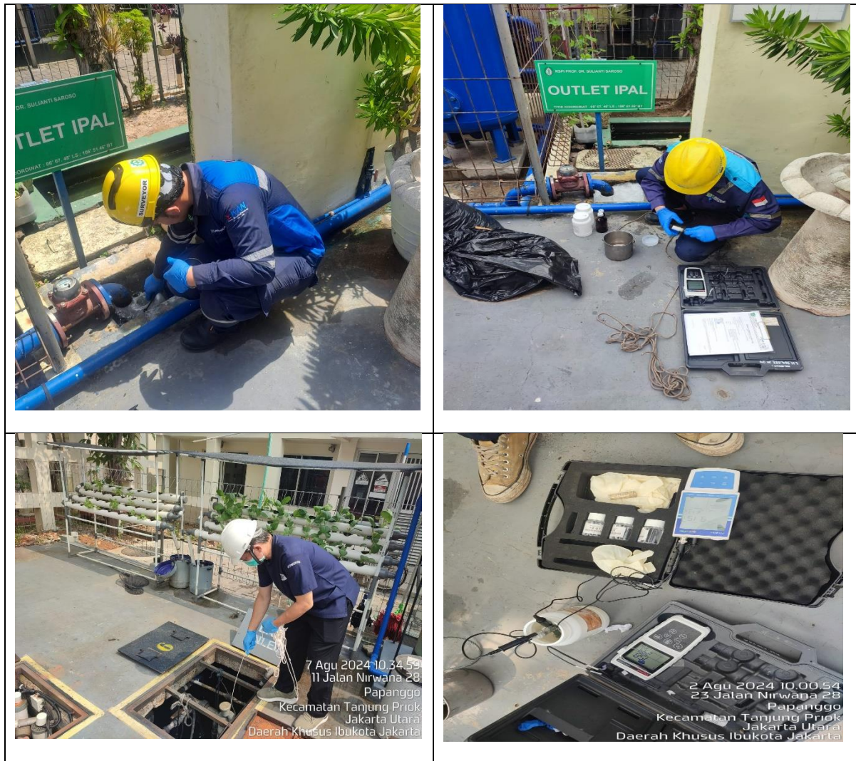
Gambar 7. Kegiatan Pengukuran Kualitas Air Limbah
