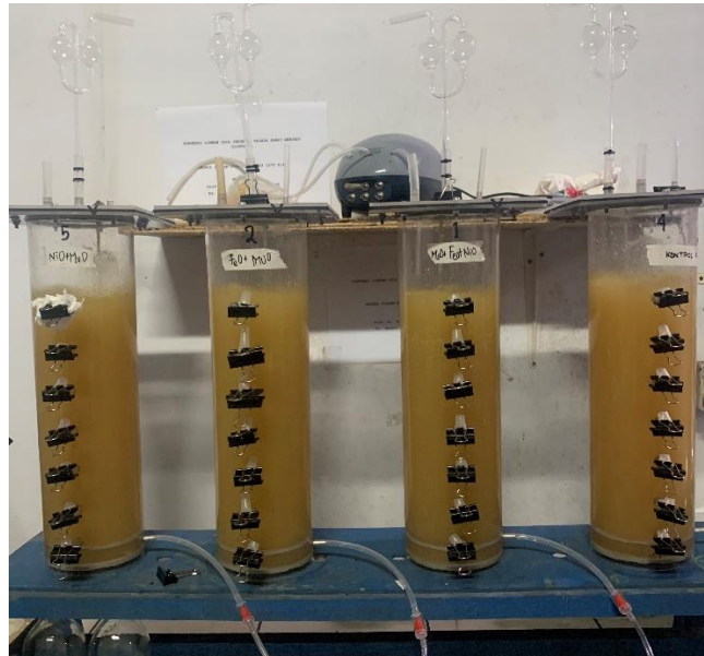
Gambar 1. Circulating Bed Reaktor skala lab pada penelitian ini.
