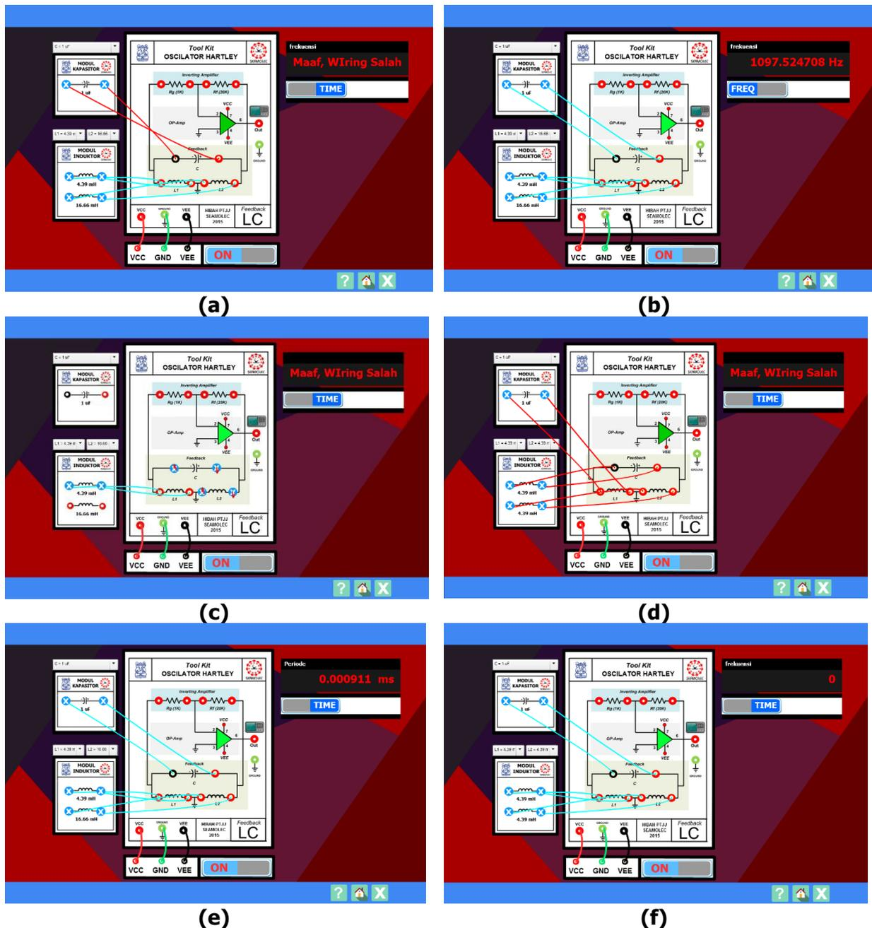
Gambar 6. Tampilan pengujian teknis *virtual laboratory*: (a) kesalahan penyambungan polaritas kaki kapasitor elektrolit; (b) hasil praktikum yang benar pada mode *frequency*; (c) penyambungan kabel jumper yang tidak lengkap; (d) penyambungan kabel yang salah; (e) hasil praktikum yang benar pada mode *time*; penyambungan L/C yang tidak tepat pada praktikum osilator Hartley dan osilator Colpitts
