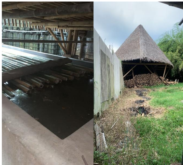
Gambar 4. Proses Perendaman Bambu pada Cairan Kimia dan Proses Pengeringan di Ruang Semi-Outdoor .
