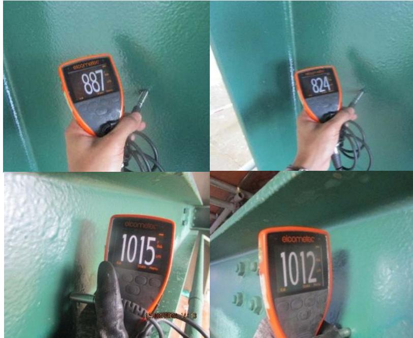
Gambar 4. Pengukuran ketebelaan lapisan Primer coat .
