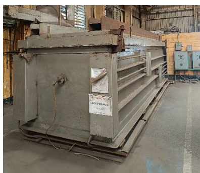
Gambar 3. Proses Post Weld Heat Treatment dengan Furnace
