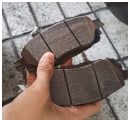
Gambar 3. Kampas rem yang tidak rata
