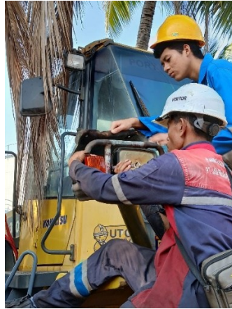
Gambar 3. Penggantian lampu wheel loader
