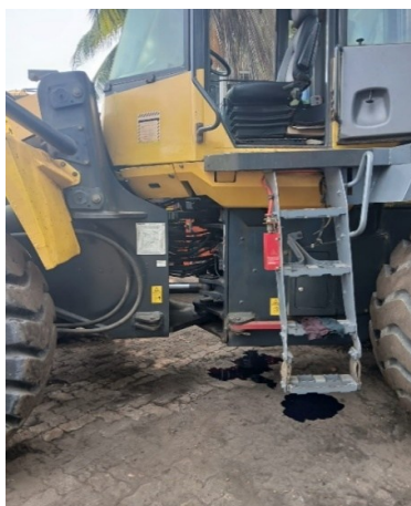
Gambar 3. Kebocoran oli pada wheel loader
