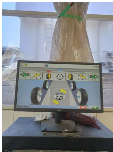
Gambar 3 Penyetelan sudut toe in-toe out , caster dan chamber
