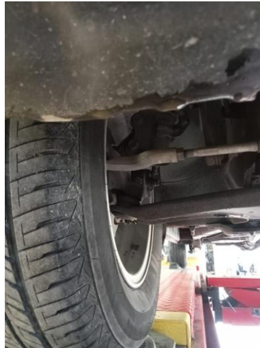
Gambar 2 Pemeriksaan Tie Rod , Ball Joint
