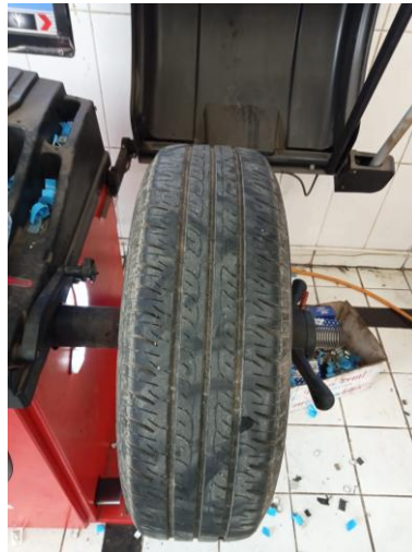
Gambar 5 Proses penyeimbangan ban
