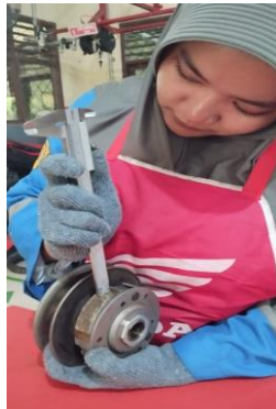
Gambar 2. Mengukur Kamvas ganda
